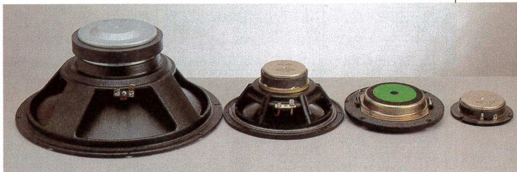
Il woofer ed il midrange basso hanno la membrana IMG, in polipropilene nel quale vengono iniettate, ad alta pressione ed alta temperatura, delle fibre di grafite, al fine di irrigidirne la struttura. Il mid-alto Polydome ha la membrana in polipropilene pilotata da una bobina mobile di ben 7,5 cm. Il tweeter Emit-R ha la bobina mobile direttamente depositata sulla membrana in kapton. L'energia è fornita da un potente magnete al neodimio.
