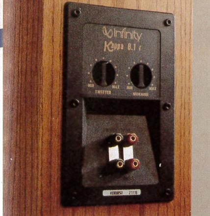
I morsetti di ingresso permettono il collegamento in bi-wiring o in bi-amplificazione. La coppia più in basso è direttamente connessa al filtro del woofer, mentre la coppia più in alto pilota i due driver per le note medie ed il tweeter.
